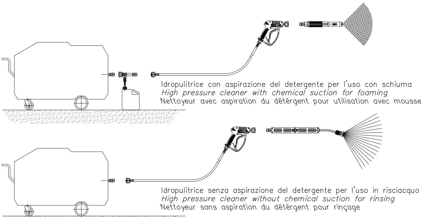
USO SU IMPIANTI FISSI DELLA LANCIA SCHIUMA LS12 CON ASPIRAZIONE ESTERNA + INIETTORE
